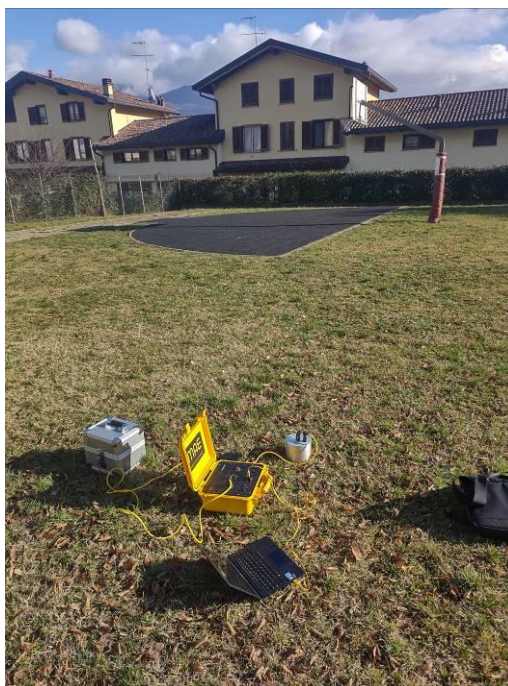
Figura 12 - Misura in sito del micro tremore ambientale.
