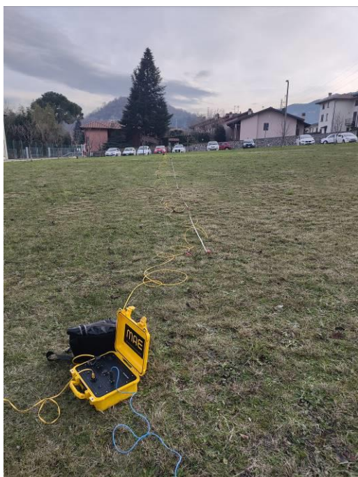
Figura 17 - Misura in sito del profilo delle onde di taglio orizzontali superficiali “Vs”.
