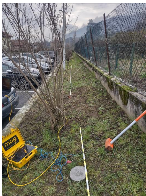
Figura 25 - Misura in sito del profilo delle onde di taglio orizzontali superficiali “Vs”.
