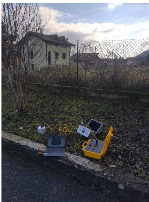
Figura 28 - Misura in sito del micro tremore ambientale.
