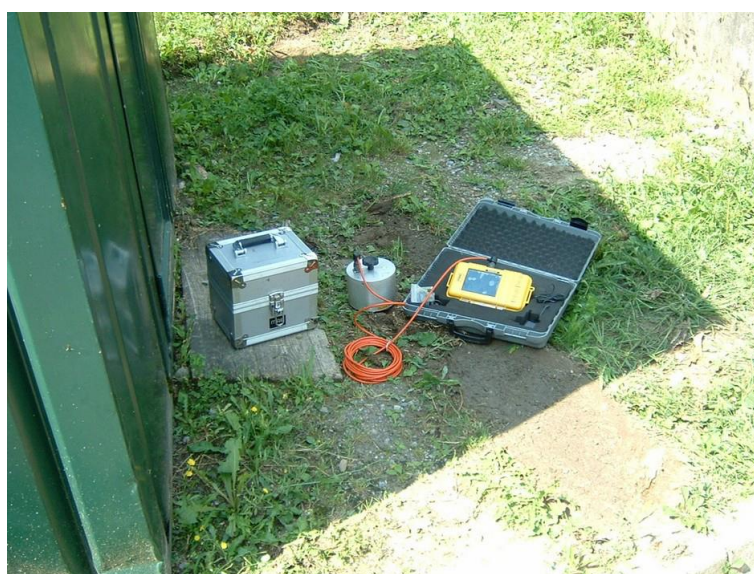
Figura 4 - Misura in sito del micro tremore ambientale.
