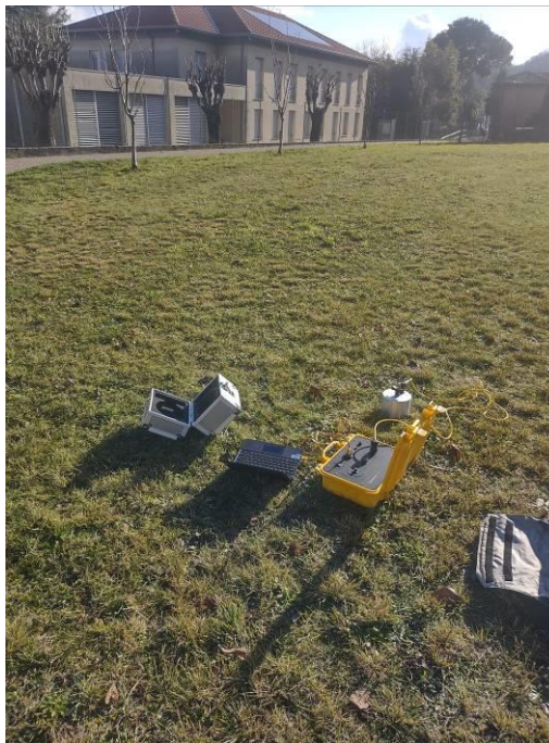
Figura 20 - Misura in sito del micro tremore ambientale.
